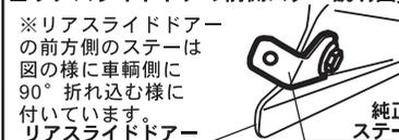
※リアスライドドアの前側側のステーは図の様に車輻側に90°折れ込む様に付いています。リアスライドドア
