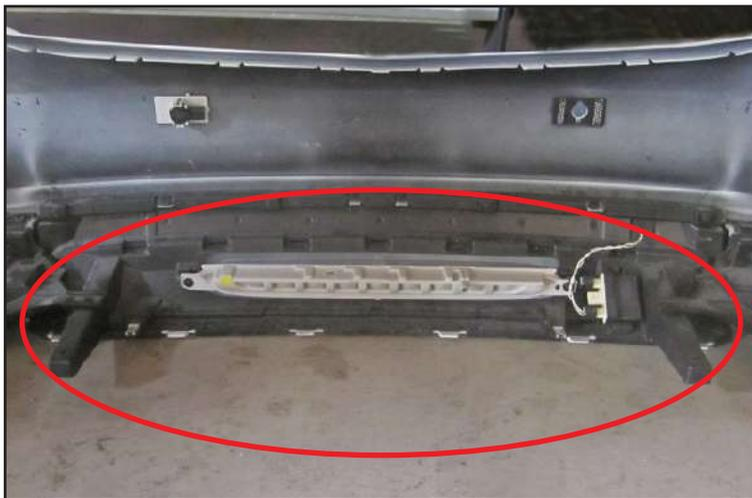
純正リアバンパーから画像丸印の部分のインナーパーツを取り外して下さい。
