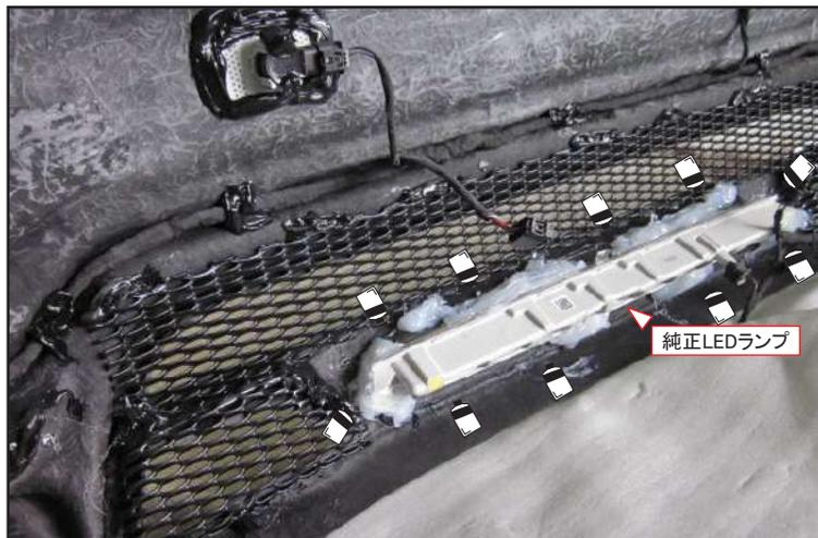
リアバンパー内側からセンターの開口部に純正LEDランプを合わせ、コーキングボンド等(別売)でリアバンパーに接着して下さい。
