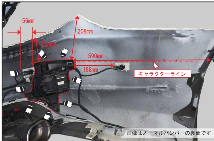
純正リアバンパーから-----で囲われたセンサーをアダプターごと取り外し、リアバンパー側に移設して下さい。
