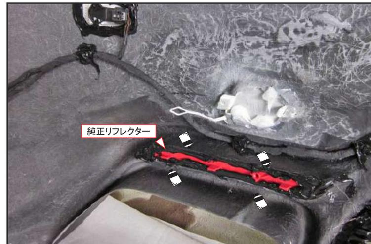
LEDランプと同様にリアバンパー内側から左右の開口部に純正リフレクターを合わせ、コーキングボンド等(別売)でリアバンパーに接着して下さい。
