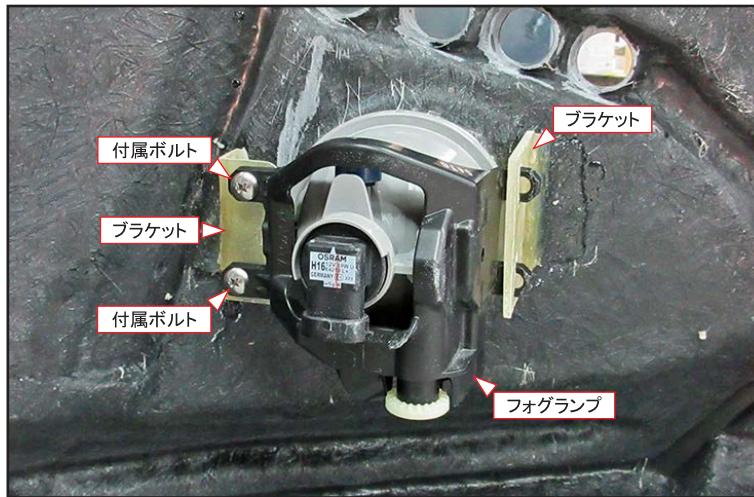
純正バンパーからフォグランプを取り外し、スポイラー内側のブラケットに固定します。 フォグランプ内側の固定部分をブラケットの穴に挿し込み、外側を付属のボルトで固定して下さい。
