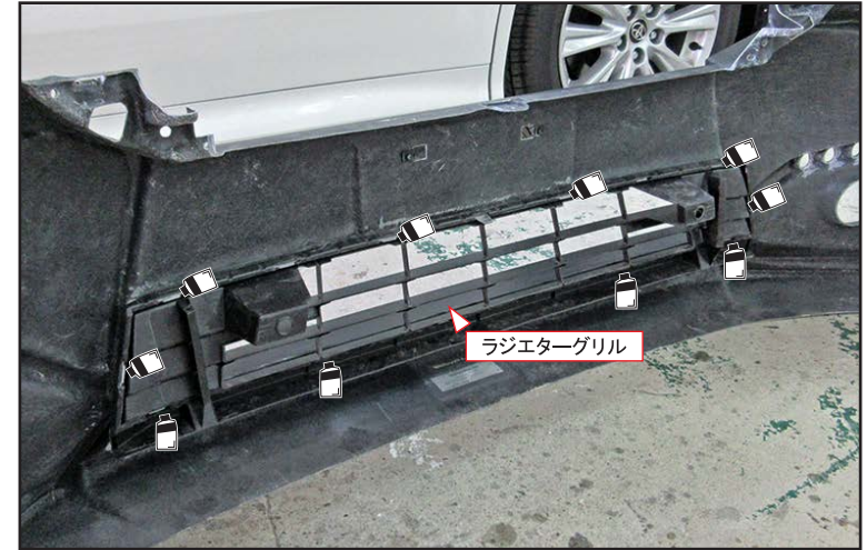
スポイラーの内側からラジエターグリルを取り付けコーキングで接着して下さい。
